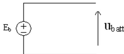
Figure III.2 : Modèle idéal batterie.
